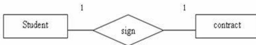
รูปภาพที่ 2.1 ความสัมพันธ์แบบ หนึ่ง-ต่อ-หนึ่ง
